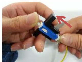
3/ 轻轻捏住光纤。向前滑动楔形夹，将听到“哒”的一声。
