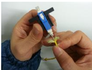
2/将完整切割的光纤慢慢插入连接器的尾部，直至连接完成为止。
