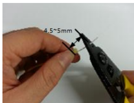
4/ 开剥掉900μm一次涂层，保留4.5~5mm的900μm紧套光纤。
