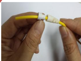
1a/ 如果是2mm或3mm光缆，将尾套和锁紧螺母套到光缆上。
