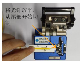
8/ 将定位垫片固定到光纤切割刀上。将光缆放置到定位垫片上(参见下图中的“a”或“b”)然后切割。
