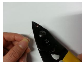
2b/ 如果是250或900μm光缆，则开剥掉约35mm涂层，然后跳到第6点
