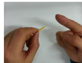
6/ 将裸纤往多方向微微弯曲60度，以测试其刚性。
