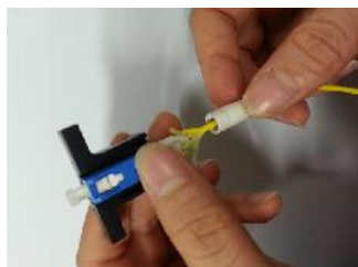
4/将芳纶平均分成两份，将锁紧螺母拧到连接器的背面以拧紧芳纶。然后，向上滑动尾套 (如果是250或900μm光缆，请跳到第5点)。
