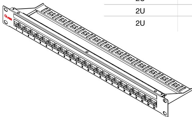
5E类，1U 24端口非屏蔽平板铜缆配线架示例
